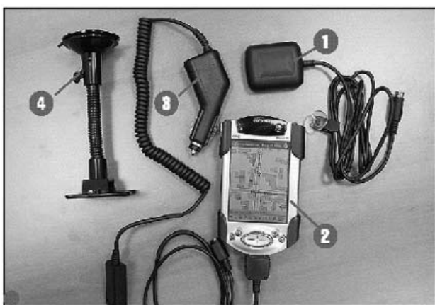
Комплект оборудования включает в себя GPS-приемник 1, карманный персональный компьютер (КПК) 2 или ноутбук и аксессуары крепления (зарядный шнур 3 и держатель КПК 4).
