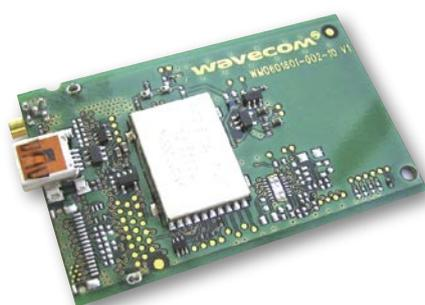
Рис. 7. Плата расширения IESM-GPS+USB
