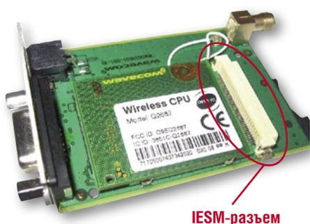
Рис. 3. 50-контактный внутренний разъем Fastrack Supreme
