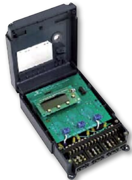
Рис. 4. Внешний вид трехфазного счетчика на основе микросхемы MСР3909 и контроллера PIC18F2520
