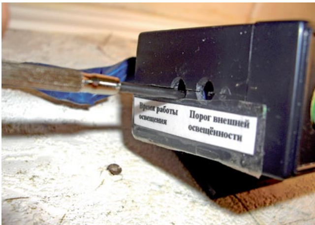
Рис. 6. Регулировка порога внешней освещенности
