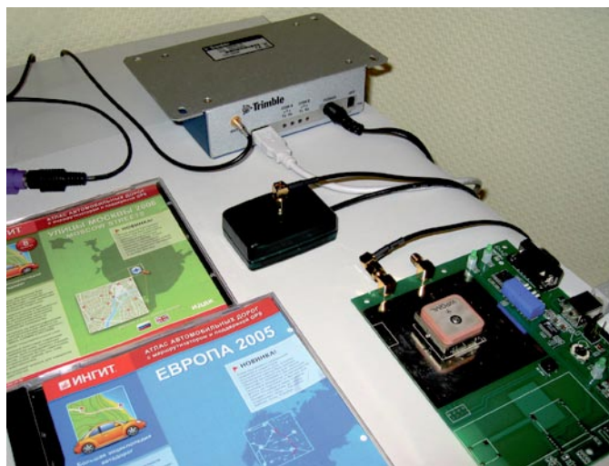
Рис. 6. Статический тест трех GPS-приемников
