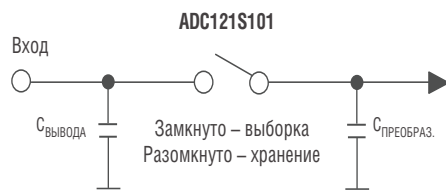
Рис. 3. Эквивалентная схема входа ADC121S101
