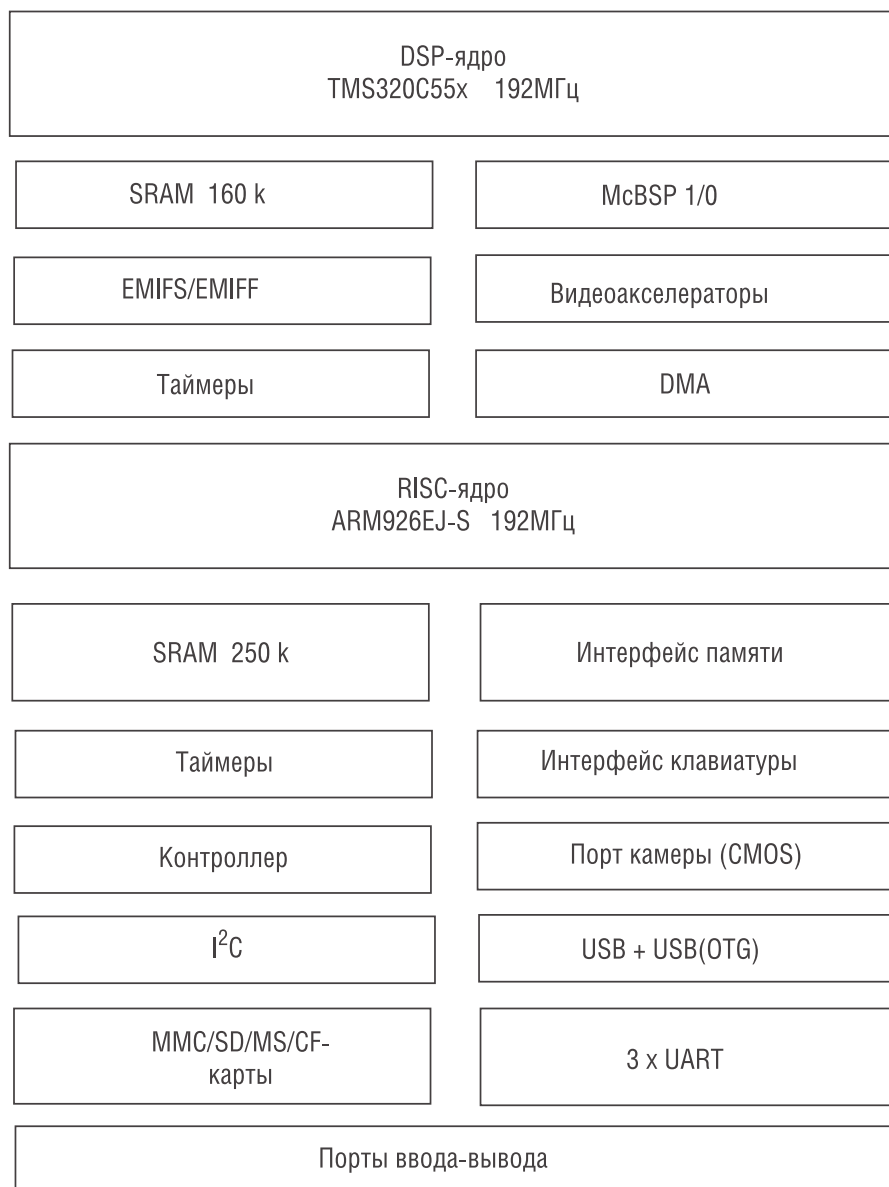
Рис. 3. Упрощенная блок-схема процессора OMAP5912
