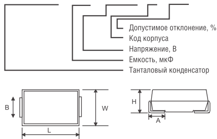
Рис. 5. Система обозначений чип-танталовых конденсаторов в базе данных компании КОМПЭЛ
