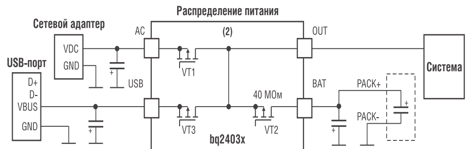
Рис. 2. Схема распределения питания при использовании bq2403x
