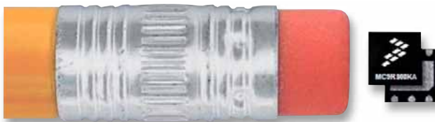
Рис. 1. Сравнительные размеры корпуса DFN
