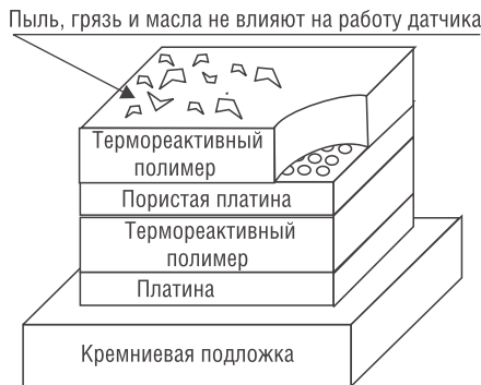
Рис. 1. Структура датчика влажности
