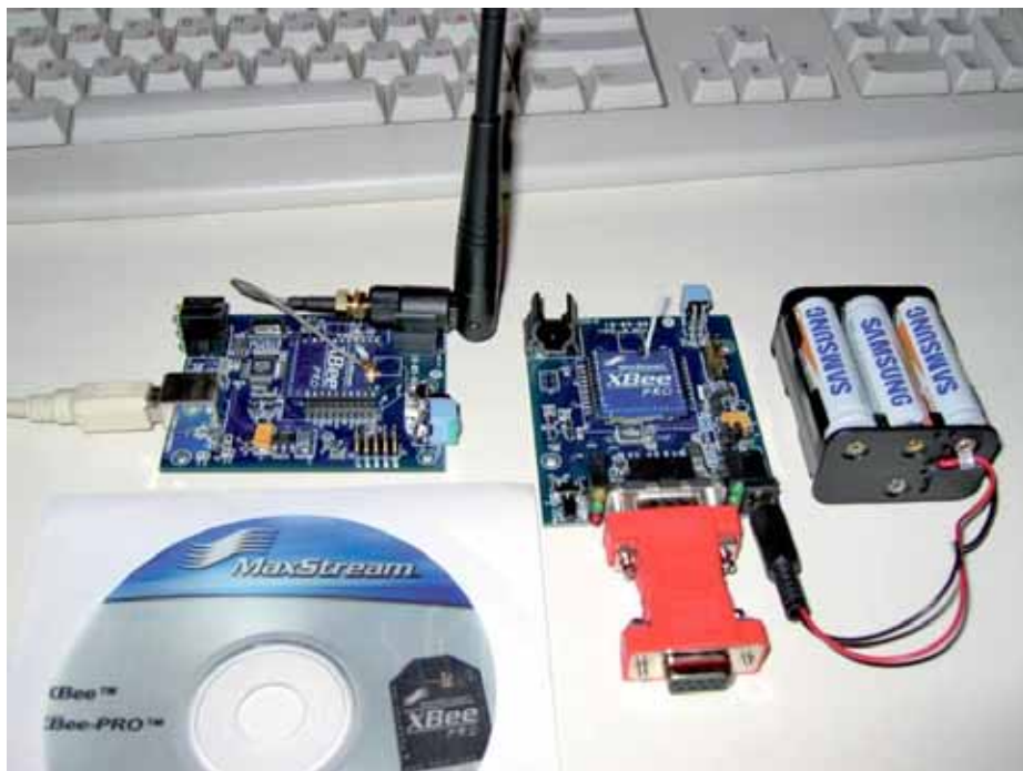
Рис. 1. Комплект оборудования для проведения теста дальности
