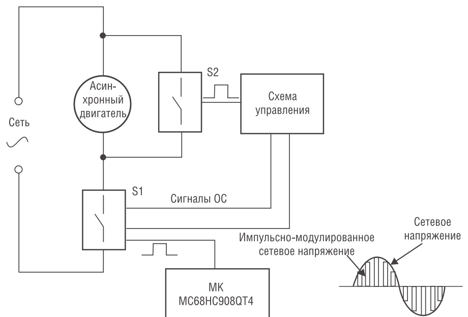
Рис. 7. Структурная схема регулируемого однофазного асинхронного привода
