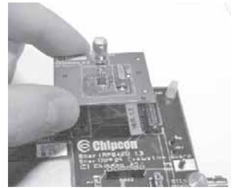
Рис. 4. Радиочастотный модуль CC1100 входит в состав отладочного комплекта
