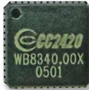
Рис. 6. CC2420 выпускается в корпусе QLP-48 размерами 7x7 мм
