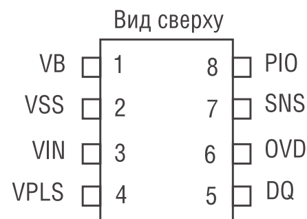
Рис. 3. Расположение выводов DS2781
